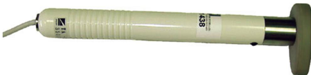
Fig. 3 : Marteau équipé d'un déclencheur électromécanique : le choc sur un tendon active un accéléromètre piézo-électrique, lequel fournit un signal de synchronisation avec un délai qui peut être quasi nul. (Nihon Kohden Corp, Bioméga Technologies)
